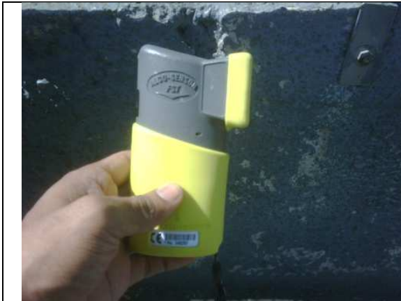
Aparato de primer contacto que sirve para detectar si el conductor tiene aliento alcohólico
